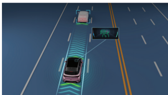
Adaptive Cruise Control (ACC) ระบบช่วยควบคุมความเร็วอัตโนมัติแบบแปรผัน
