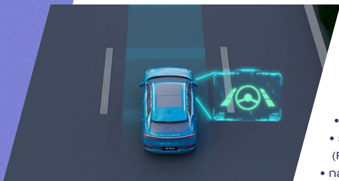
ระบบช่วยควบคุมรถให้อยู่ในช่องทางเดินรถ (Lane Keeping Assist : LKA)
